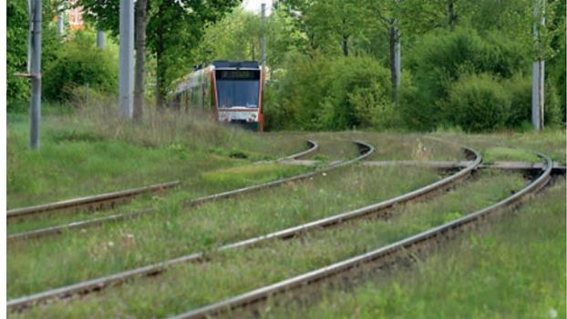
Rund 10 Kilometer der Gleise sind sogenannte Schottergleise. Dort muss regelmäßig Unkraut entfernt werden. Das machen die swa nicht mit Herbiziden, sondern mit heißem Wasserdampf.
