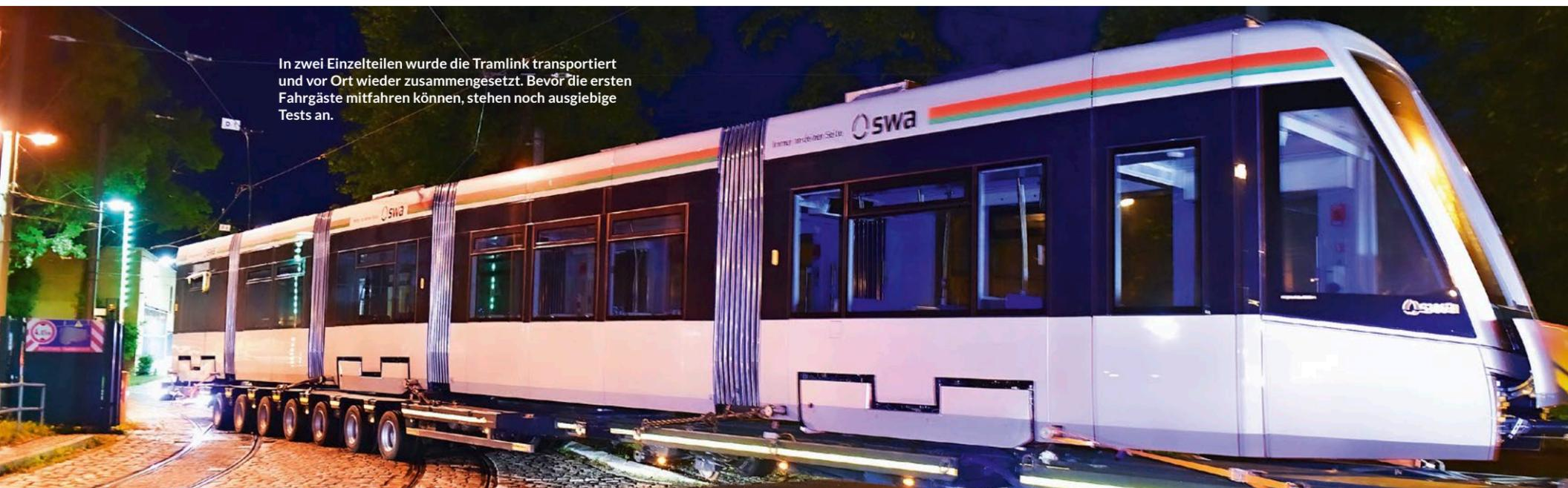
In zwei Einzelteilen wurde die Tramlink transportiert und vor Ort wieder zusammengesetzt. Bevor die ersten Fahrgäste mitfahren können, stehen noch ausgiebige Tests an.
